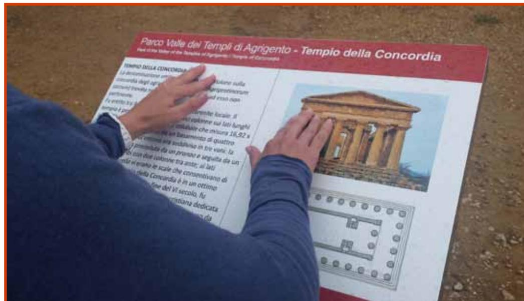
Le mappe tattili devono essere integrate al percorso tattile, disposte su appositi leggii, con un inclinazione di lettura di 30° con il bordo inferiore che non va sotto i 95 cm o collocate a parete ad un'altezza che va da 1 a 1,80 cm
